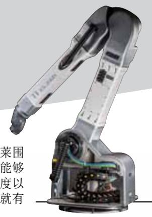
机器人系列是特意设计用于旋转运动。在不断的技术革新中，布莱围世公司改进了环形拖链的概念。由于链节的特殊构造，使之最多能够旋转540度。“机器人”系列的拖链都具有自支撑能力并且在200度以内的角度是不需要任何辅助支撑的。对于超出这个值的旋转应用就有必要使用适当的附件，例如支撑滚轮或者支撑挂钩。
